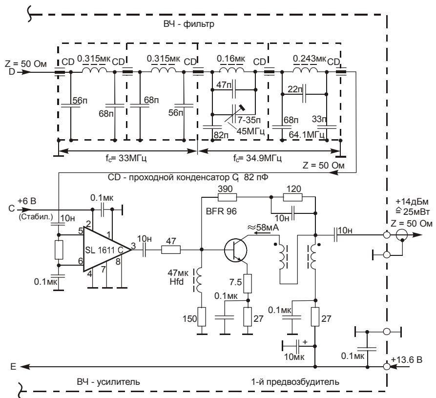
Принципиальная схема малосигнального ВЧ - тракта с селектором, усилителем и 1-м предвоздбудителем
