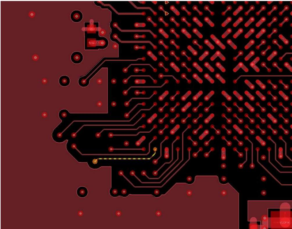
Afortunadamente, el cable recorre una corta distancia en la capa superior de la placa de circuito y, por lo tanto, se puede tocar fácilmente:
